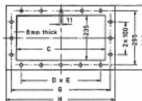
Толщина фланца 8 мм
